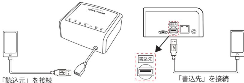
「読込元」携帯電話が接続されたことを認識すると [読込中] の LED、「書込先」携帯電話が接続されたことを認識すると [書込中] の LED が、「点滅」から「点灯」へ変わります。
