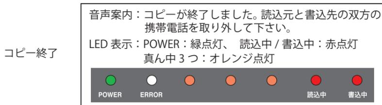
5. 「読込元」「書込先」双方の携帯電話を取り外し、コピー操作を完了します。音声案内が流れた後、「利用可能状態」（手順 1）に戻ります。
