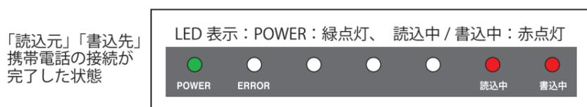
3. 携帯電話を接続すれば、自動でデータのコピーが始まります。コピーには、携帯電話の機種やデータ量などにより、相応の時間がかかります。
