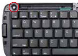
「電池警告LED」はキーボードの電池残量が少なくなると赤く点滅します。点滅を始めたからお早めに新しい電池と交換して下さい。
