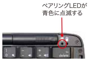
ペアリングのタイムアウト時間は10分間です。時間内に以下2~3の手順に成功しませんでした、キーボードがスリープモードに入りLEDが消灯します。
